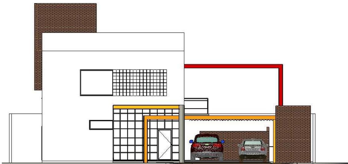
É possível criar vistas de elevação exteriores e interiores adicionais. As vistas de elevação internas mostram vistas detalhadas de paredes internas e mostram como os recursos da parede deveriam ser construídos. Cozinhas e banheiros são exemplos de ambientes que podem ser mostrados em uma elevação interna.
