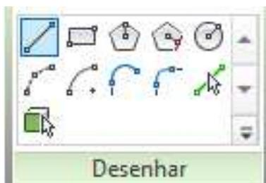
*Figura: Painel de desenho – opções de desenho de paredes.*
