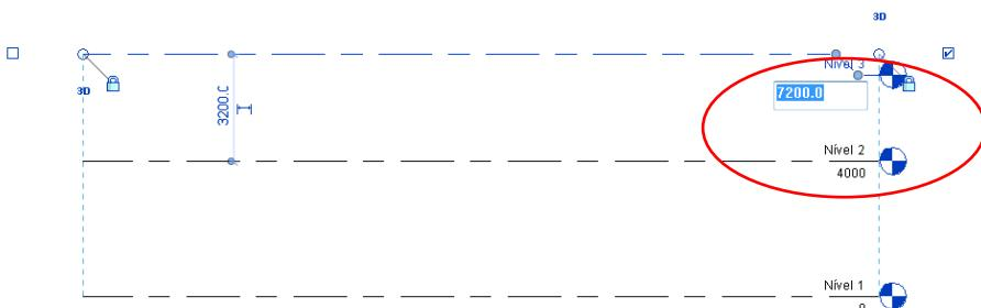
Figura: Alterando o valor da cota de nível.
