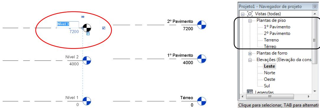
Figura: Alterando no nome do pavimento do nível criado.
