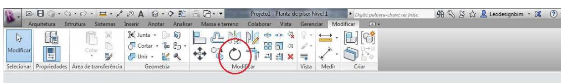
Figura: Ferramenta Rotacionar.
