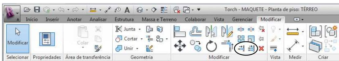
Figura : Ferramenta Cortar/Estender elemento único (Trim).
